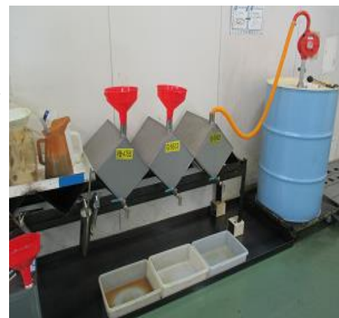
有機溶剤の計量注入と漏れ対策
