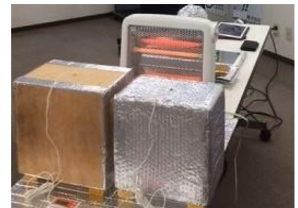
【遮熱材と断熱材の違い実験】
