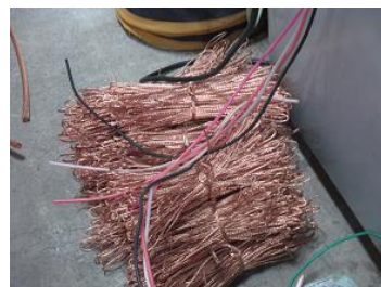
被覆を剥いだ電線
