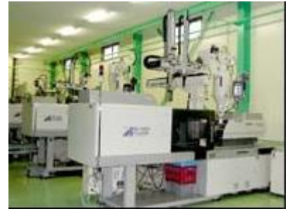
樹脂成型設備
