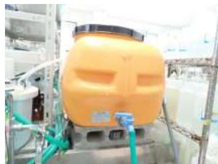
冷却水の再利用(貯留タンク)
